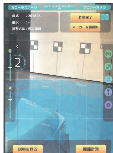
AR技術で、実際の映像の上にCGでターゲット設置位置を表示する
